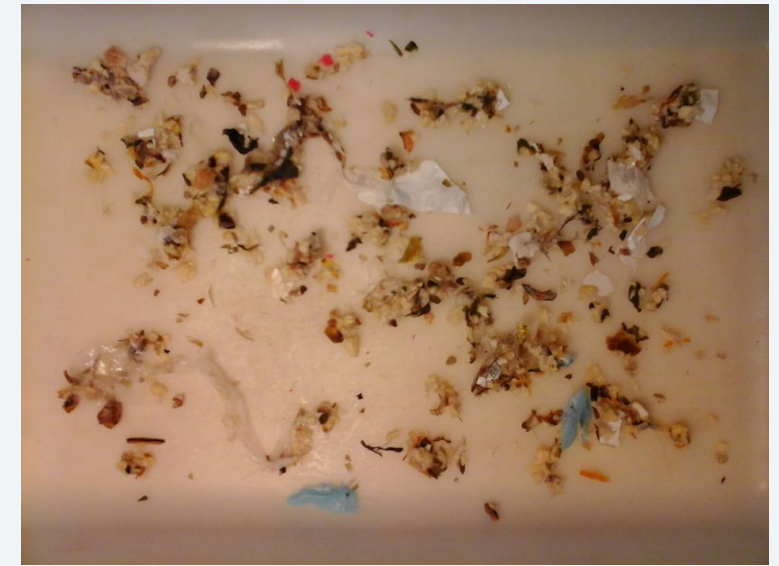
Mesure d'indésirables dans soupes agro alimentaires avant méthanisation
